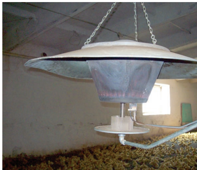
Рис. 2. Брудер газовий EV2 Class D у пташнику для вирощування каченят
