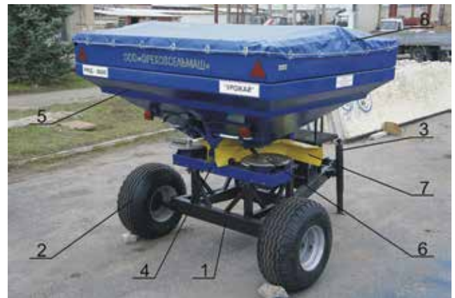
Рис. 1. Загальний вигляд розкидача мінеральних добрив РМД-3000: 1 – технологічне шасі; 2 – колісний вузол; 3 – опора; 4 – рама; 5 – бункер; 6 – тукорозсівний апарат; 7 – кожух; 8 – тент
