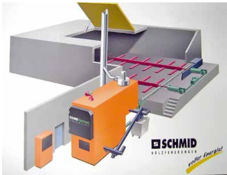
Рис. 3. Принципова схема котельні, що працює на відходах деревини
