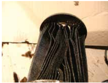
Деформований і порваний фільтр
