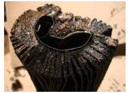
Деформований фільтрувальний елемент із зірваним бандажем. Добре видно сліди неякісного приклеювання
