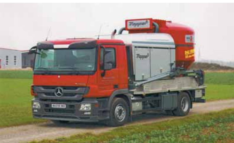
Рис. 2. Мобільний комбікормовий завод MIX 6216 QAD фірми Tropper (Австрія)
