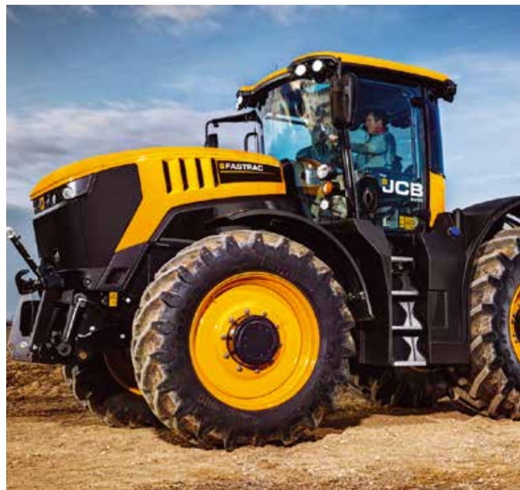
Шини англіїцями було збільшено. Ззаду зараз пропонується балони висотою аж 1,96 м 900/50 R 42, а спереду – 650/65 R 34, з ними загальна ширина перевищує 2,55 м
