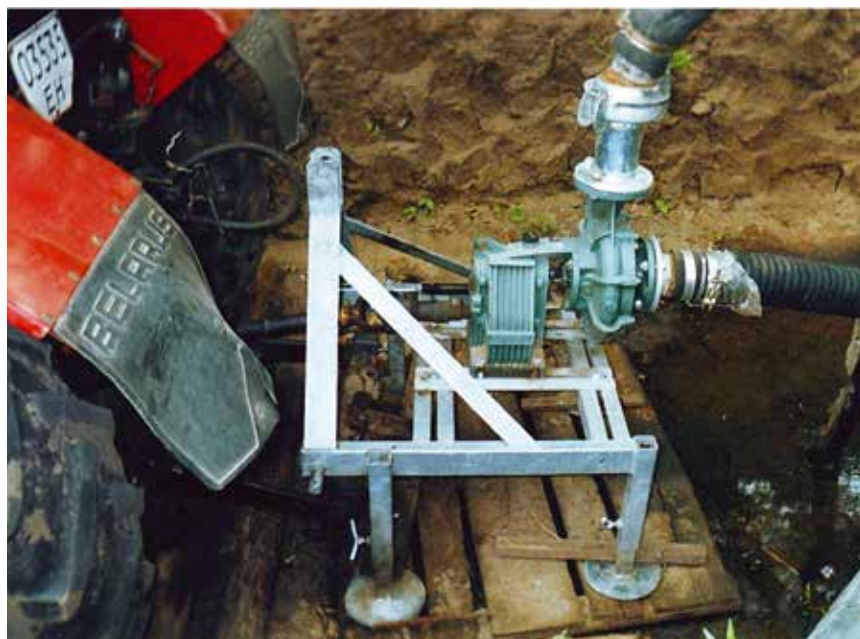
Рис. 4. Пересувна насосна станція з приводом від ВВП трактора МЕС-D3/65 (Caprari S.p.A., Італія)
