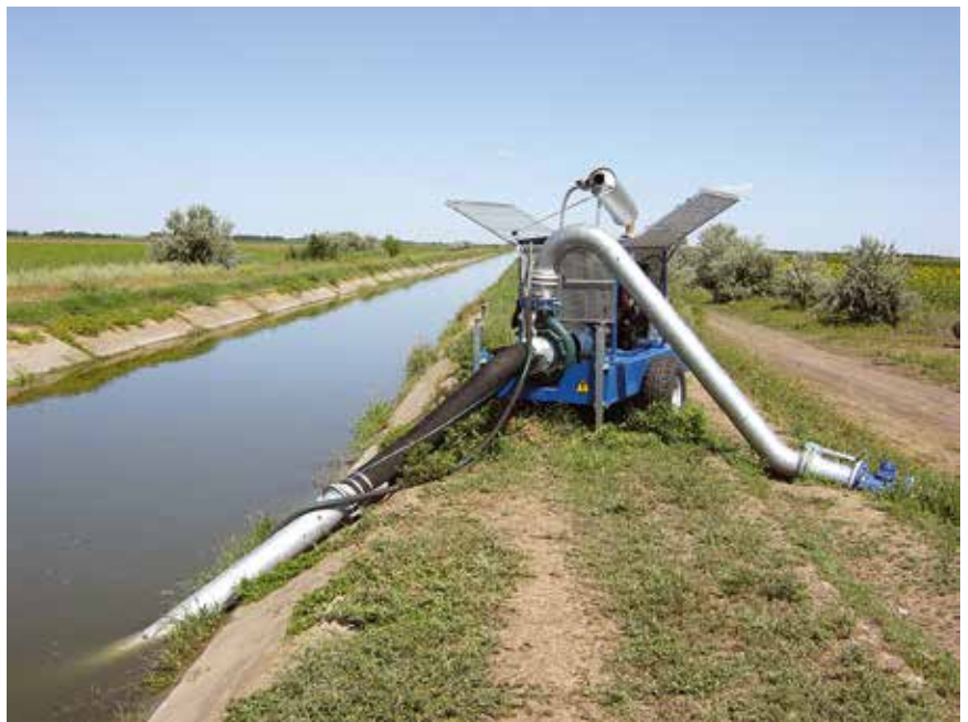
Рис. 2. Пересувна насосна станція з дизельним приводом Idrofoglia (Idrofoglia Srl, Італія)
