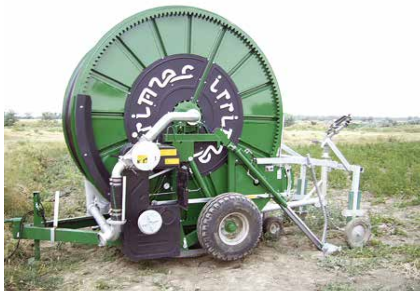
Рис. 7. Дощувальна машина шланго-барабанного типу MF 3-110 TG 600 (Irrites, Італія)
