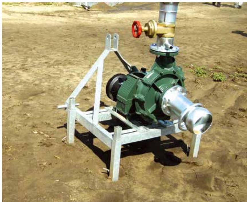
Рис. 6. Загальний вигляд насосної станції MEC-D3/65
