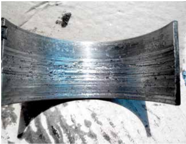
Інтенсивний знос вкладишів колінчастого вала — наслідок неякісного очищення оливи фільтром
