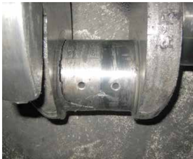
Знос шатунної шийки колінчастого вала та її руйнування – наслідок порушення правил експлуатації двигуна
