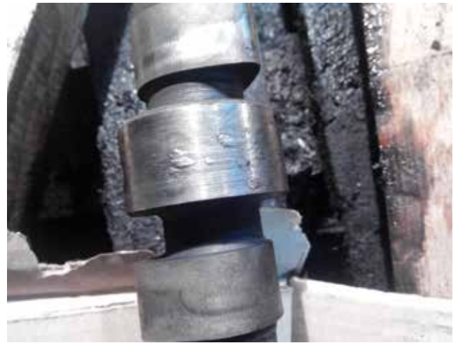
Напливи на опорних шийках розподільного вала — наслідок недостатньої кількості оливи для мащення пар тертя
