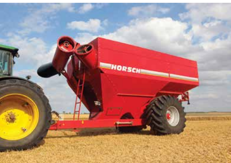
Машини Horsch мають телескопічну вісь, що дає змогу змінювати ширину колії в межах від 3,00 до 3,56 м
