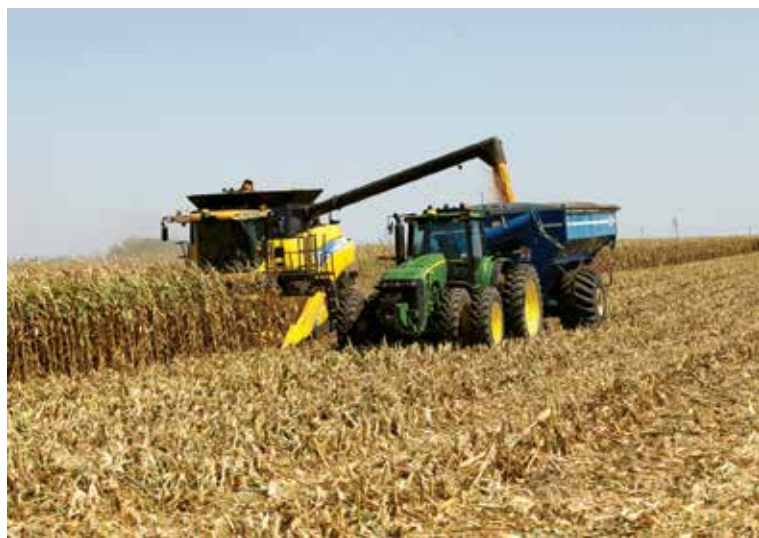
Один причін Harvest Commander моделі 1050 здатен вмістити одночасно зерно від трьох комбайнів
