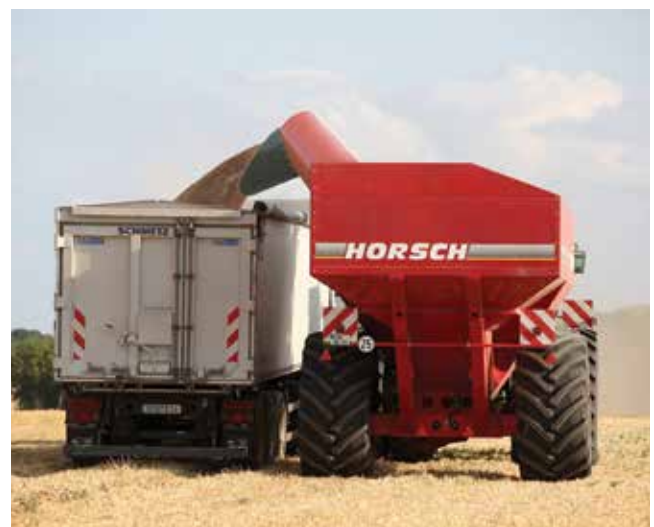
Машини Horsch мають телескопічну вісь, що дає змогу змінювати ширину колії в межах від 3,00 до 3,56 м
