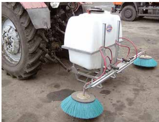
Обприскувач для внесення гербіцидів GDE 400 з розміщенням робочої штанги в задній частині агрегату (Off. Месс. Panari Giancarlo & C. s.n.c., Італія)
