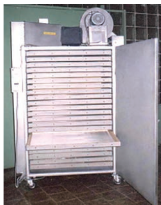
Зліва: сушильна камера. Діапазон регулювання температури в камері – від 20 \pm 10 до 60^\circ\text{C} . Корисне навантаження: на один піддон – 24 кг; на камеру в цілому – 528 кг. Повна завантаження камери ядром ореха – 250-300 кг в залежності від розміру фракції. Максимальна споживана потужність – 6,55 кВт (в т.ч. потужність ТЭНов – 6 кВт). Габаритні розміри – 1409 x 1100 x 2285 мм. Вага – 360 кг.
