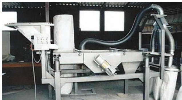
Вибросито-калібратор. Продуктивність машини – 850 кг/час (середня для ядер грецького ореха). Напруга живлення – 380 В. Потребляемая мощность – 3,5 кВт. Маса машини – 800 кг. Габарити – 3957 x 2596 x 2563 мм.
