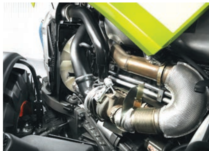
Рис. 4. Загальний вигляд системи SCR
