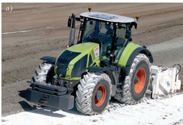
Рис. 5. Конструкційні рішення для підвищення тягово-зчіпних характеристик та маневреності тракторів: а – трактор із баластним вантажем; б – встановлення коліс переднього моста
