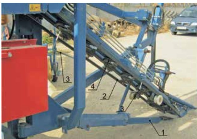
1 – підкопувальний леміш; 2 – пасовий транспортер; 3 – штанги видалення ґрунту; 4 – притискні ролики;
