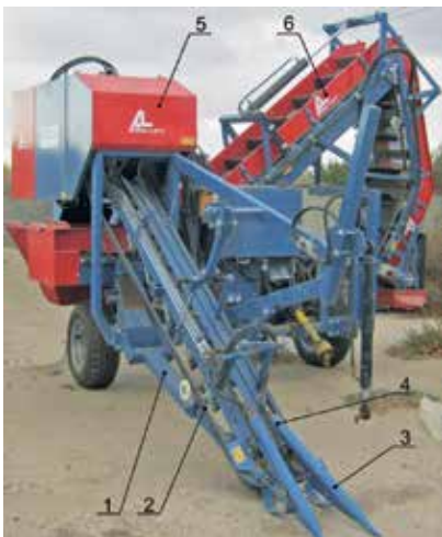
1 – підкопувальний леміш; 2 – пасовий транспортер; 3 – торпедний подільник; 4 – гідромотор привода торпеди; 5 – оголодження механізму видалення бадилля; 6 – вивантажувальний транспортер
