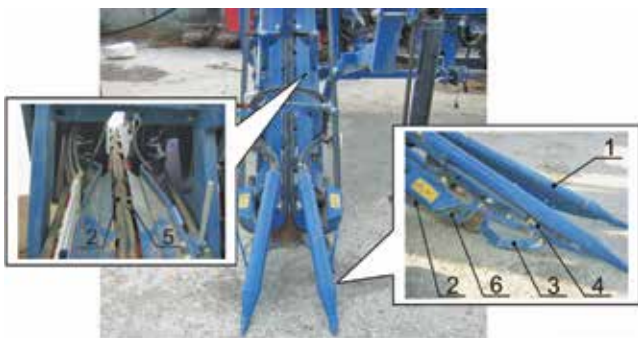
1 – торпедний подільник; 2 – пасовий транспортер; 3 – кронштейн механізму автоматичного контролю глибини підкопування; 4 – магнітний датчик; 5 – притискні ролики; 6 – нижній натяжний шків пасового транспортера
